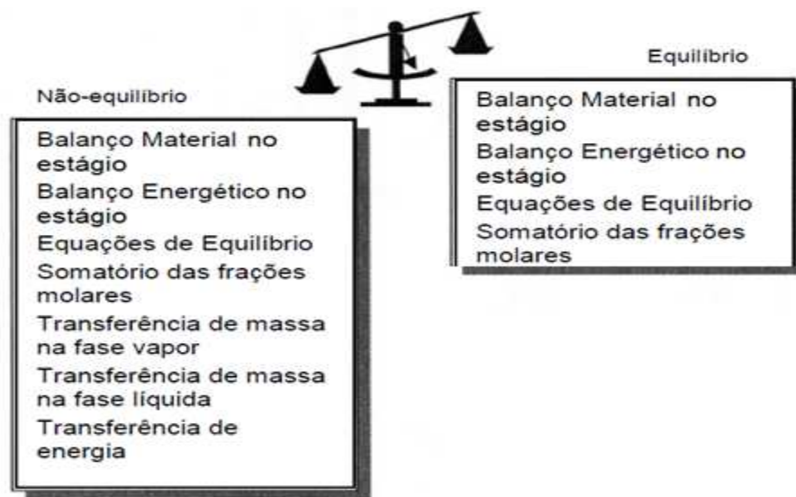
Figura 3.3: Comparativo entre os modelos de equilíbrio e não equilíbrio (Taylor et al., 2003)
