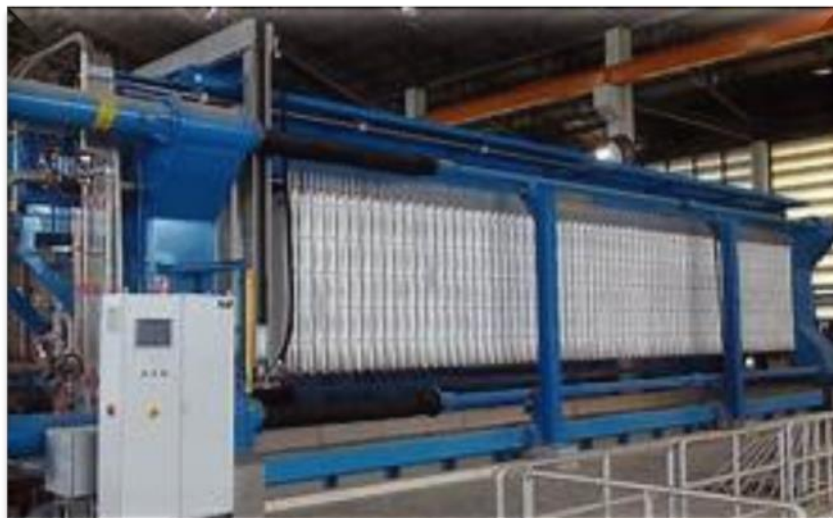
Figura 7 Filtração do mosto cervejeiro por fitro prensa
