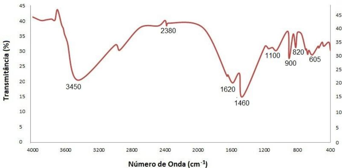
Figura 19: Espectro de infravermelho obtido para o resíduo sólido resultante da evaporação do lixiviado proveniente do AGR.
