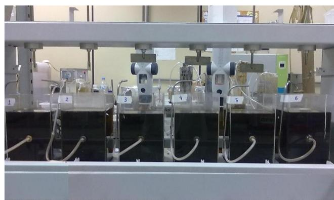
Figura 16: Aparelhagem de “Jar-Test” utilizada nos experimentos de coagulação/flocação
