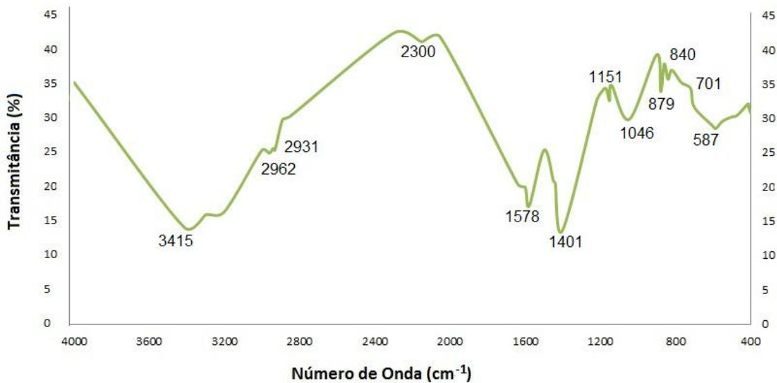
Figura 20: Espectro de infravermelho obtido para o resíduo sólido resultante da evaporação do lixiviado proveniente do ASE.
