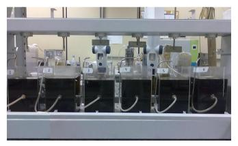
Figura 16: Aparelhagem de "Jar-Test" utilizada nos experimentos de coagulação/floculação
