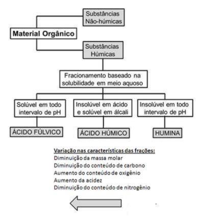
Figura 5: Esquema de fracionamento do material orgânico e das substâncias húmicas presentes no solo (Adaptado de ROSA, 1998).
