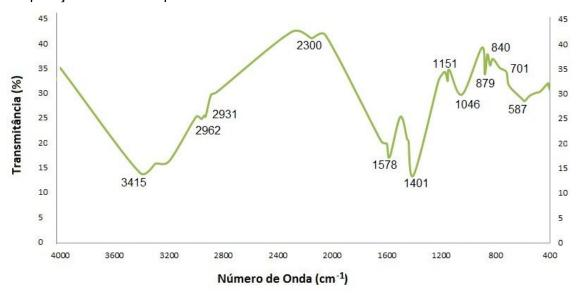
Figura 20: Espectro de infravermelho obtido para o resíduo sólido resultante da evaporação do lixiviado proveniente do ASE.
